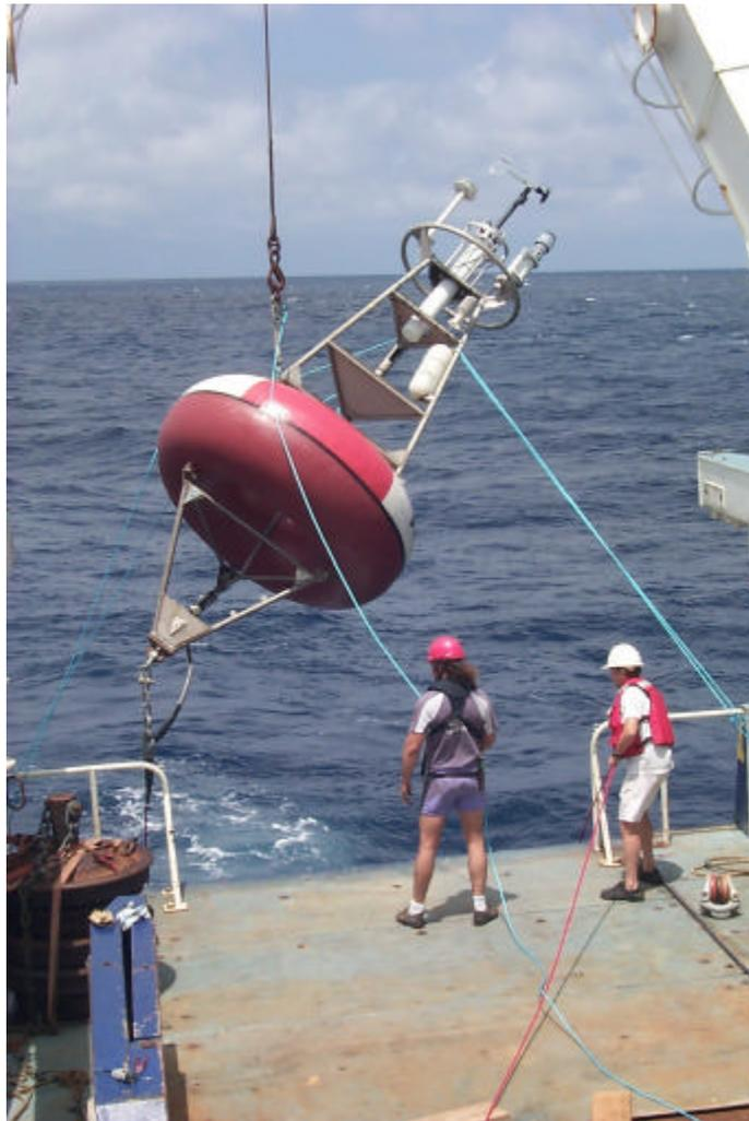
Figure 1 : Mise à l'eau d'une bouée ATLAS à bord du N/O La Thalassa
