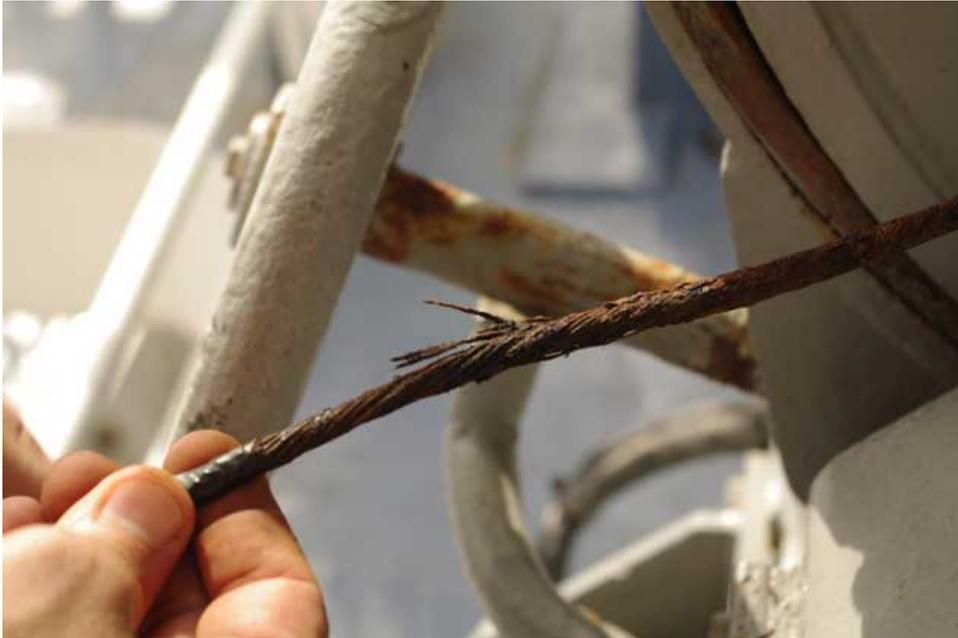
**Figure 8 : Etat du câble en sortie de tambour vers BJ – collecteur tournant**
