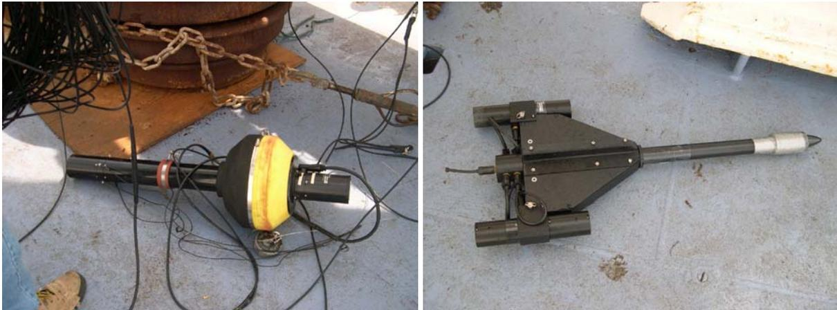
Cet appareil permet la mesure du rayonnement solaire incident et réfléchi à la surface de l'océan (à gauche) et de 0m à 100m de profondeur (à droite). Il permet le calcul de la réflectance et de l'absorption de la lumière solaire dans la colonne d'eau.
