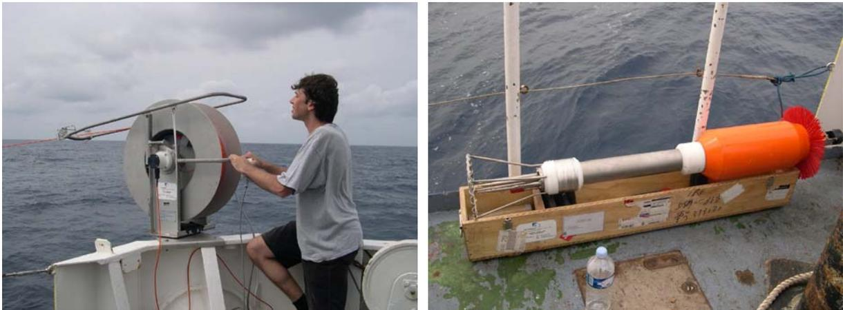
Cette appareil (MSS pour "Micro Structure Sensor") permet de mesurer la variation de la vitesse de l'eau de mer dans les trois directions et la température, avec une fréquence d'acquisition de 1000/sec (100 mesures/sec sont significatives) et une résolution spatiale de 0.6mm. Il peut fonctionner jusqu'à des profondeurs de 0 à 2000m, mais n'est utilisé à bord que pour étudier les microstructures des couches supérieures de l'océan, jusqu'à 250m.
