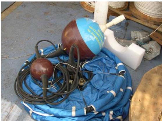
SVP = Surface Velocity Profiler. Ces appareils sont équipés d'une bouée munie d'un émetteur Argos permettant la transmission quotidienne de leur position par GPS (pour qu'ils dérivent bien en suivant le courant océanique de surface, et non pas sous l'influence du vent, une ancre flottante -"parachute" bleu- est positionnée à 15 m sous la surface).
