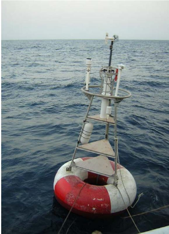
Ces bouées sont des stations météorologiques positionnées en plein océan, maintenues en place en étant reliées au fond de l'océan (parfois plus de 5000m) à un lest de 2 tonnes par un câble (en acier protégé d'une gaine en plastique jusqu'à 800m puis en nylon).
