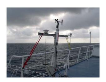
1) Sur cette structure en forme de croix sont installés 4 instruments déjà mentionnés précédemment, qui sont: 1 pyranomètre (mesure du rayonnement visible), 1 pyrgéomètre (mesure du rayonnement infrarouge), 1 thermomètre et 1 anémomètre Young.
