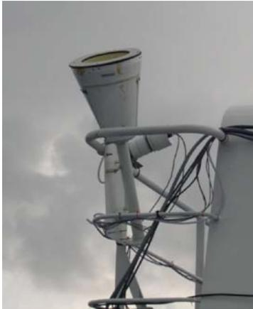
Cet instrument mesure la température des précipitations (des gouttes de pluie).
