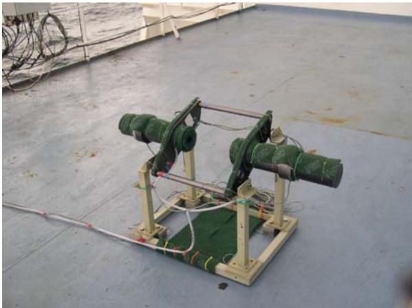
Cet instrument mesure la taille et le nombre des gouttes de pluie, par absorption d'un faisceau infrarouge.
