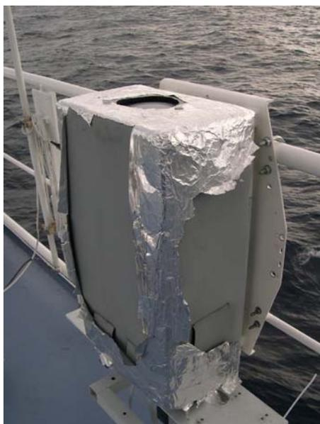
Cet instrument mesure le rayonnement électromagnétique à 23GHz et 36GHz (raies de H<sub>2</sub>O). Il permet ainsi de connaître le contenu intégré en vapeur d'eau et en eau liquide sur la colonne d'air située au-dessus du navire.
