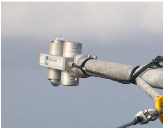
Ces instruments mesurent le rayonnement visible (pyranomètre, de  $0.3$  à  $3 \mu\text{m}$ ) et infrarouge (pyrgéomètre, de  $5$  à  $45 \mu\text{m}$ ) émis par le ciel (demi-sphère supérieure) et émis, réfléchi par la mer (demi-sphère inférieure).
