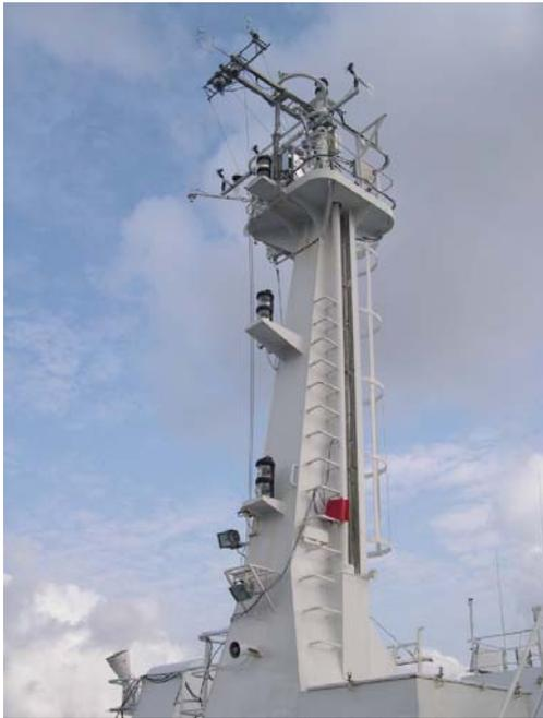
Les instruments sont placés en haut du mât, entre 17 et 18m au dessus de la surface de la mer.
