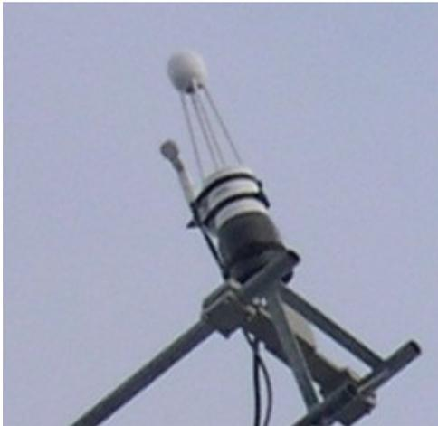
Cet instrument effectue des mesures du gaz carbonique ( $\text{CO}_2$ ) et de l'humidité (eau=particules d'  $\text{H}_2\text{O}$ ), à haute fréquence (20Hz). Principe : absorption d'un faisceau infrarouge émis dans une raie du  $\text{CO}_2$  et de  $\text{H}_2\text{O}$ .
