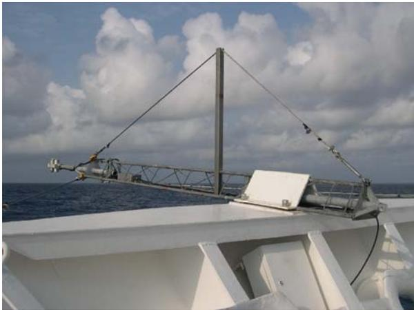
Ce mât est équipé d'instruments appelés pyranomètre et pyrgéomètre
