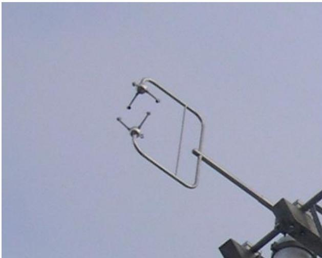
Ces instruments mesurent respectivement la vitesse du vent dans les trois directions (méridienne, zonale et verticale) et la température de l'air. Ces paramètres sont indispensables pour l'étude des flux (de chaleur et d'humidité) à la surface de l'océan.
