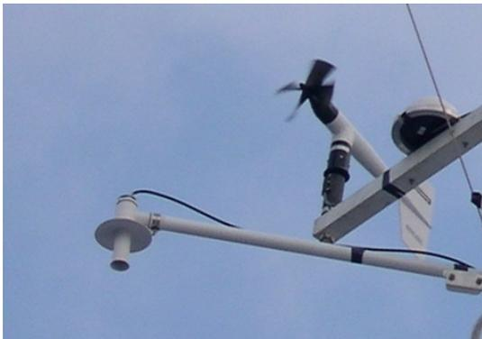
Ces instruments sont situés à 1.50m en-dessous des instruments à haute fréquence décrits ci-dessus. Leur fréquence d'acquisition est de 2s (soit 1 mesure toutes les 2 secondes) pour l'anémomètre (mesure de la vitesse et de la direction du vent) et de 10s pour le thermomètre (mesure de la température) et l'hygromètre (mesure du contenu en eau de l'air -ou humidité-). Ces instruments sont doublés de part et d'autre du mât.
