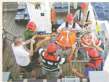
b) L'obs est saisi par plusieurs filins afin d'éviter qu'il ne se balance trop à cause du roulis lors de la mise à bord.
