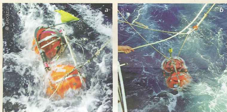
a) L'obs vient d'être saisi depuis le bord grâce à une gaffe, il doit maintenant être mis à bord aussi rapidement que possible pour éviter que les vagues ne l'endommagent.
